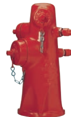
AVK serie 24/90 Bovengrondse brandkraan "Wet barrel" 2 x 2 1/2" aansluiting en 1 x 4" 1/2" motorspuitaansluiting, incl. blindkappen Nodulair gietijzer 13,7 bar (200 PSI) UL listed, FM approved
