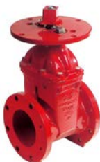
AVK serie 45/59 Flensafsluiter met montageplaat geschikt voor postindicator DN 50-300 17,2 bar (250 PSI) DN 350-400 13,7 bar (200 PSI) Nodulair gietijzer UL /ULC listed, FM approved Optie: flensboring volgens ANSI klasse 150
