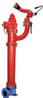
AVK serie 27 Bovengrondse brandkraan dry barrel Nodulair gietijzer 17,2 bar (250 PSI) Gronddekking 350-2438 mm UL /ULC listed, FM approved
