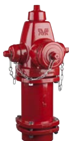
AVK serie 27/00 Bovengrondse brandkraan dry barrel ANSI B16.1 2 x 2" aansluiting en 1 x 4" motorspuitaansluiting, incl. blindkappen Nodulair gietijzer 17,2 bar (250 PSI) Gronddekking 350-2438 mm UL /ULC listed, FM approved
