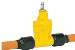
AVK serie 36/9X Dienstleidingafsluiter met PE 100 / PN 10 of 4 uiteinden, Nodulair gietijzer DN 25-50 drukklasse PN 10
