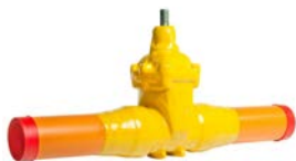
AVK serie 36/90 Afsluiter met PE 100/SDR 11 lasuiteinden, met onder druk verwisselbare O-ring constructie, uitwendig voorzien van gele polyurethaan coating Nodulair gietijzer DN 50-600 drukklasse PN 10
