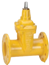
AVK serie 02/70 Flensafsluiter, lange bouw lengte, F5, met onder druk verwisselbare O-ring constructie Nodulair gietijzer DN 40-500 drukklasse PN 16
