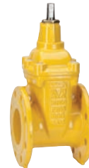
AVK serie 06/70 Flensafsluiter, korte bouw lengte, F4, met onder druk verwisselbare O-ring constructie Nodulair gietijzer DN 40-600 drukklasse PN 16
