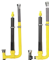
AVK serie 971 Gasafblaasunit, variabele of boven aanboring voor onder druk aanboren op stalen leiding, uitwendig voorzien van polyurethaan coating DN 50 drukklasse PN 16
