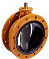
AVK serie 75/20 Centrische vlinderklep met gevulkaniseerde voering, dubbel geflensd (kort), type EVFS, inbouw lengte DIN 3202-F16 Nodulair gietijzer DN 50-2000 drukklasse PN 10/16
