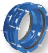
Serie 258 Gefabriceerde rechte koppeling voor AC, staal, grijs of nodulair gietijzeren buizen DN 350-2000 PN 10 tot 25
