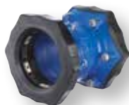
Serie 631 Supa Maxi™ rechte koppeling Universeel en trekvast voor alle buizen DN 50-400 PN 16
