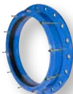
Serie 05 Combiflens voor nodulair gietijzeren buizen Trekvast DN 50-300 PN 10/16
