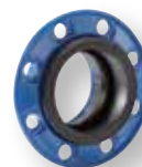
Serie 05 Combiflens voor nodulair gietijzeren buizen Niet-Trekvast DN 50-600 PN 10/16
