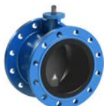
AVK serie 75/21 Centrische vlinderklep met ge vulkaniseerde voering Dubbel geflensd (lang), type EVFL Inbouw lengte DIN 3202-F4 Nodulair gietijzer DN 50-1000 Drukklass PN 10/16
