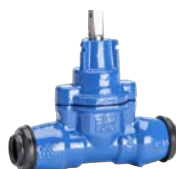
AVK serie 03/30 Dienstleidingafsluiter met trekvaste insteekverbindingen voor PE buizen Nodulair gietijzer DN 25-50 Drukklasse PN 16
