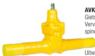
AVK serie 36/9X Dienstleidingafsluiter met PE uiteinden SDR11/PN10 of SDR17/PN4 Vervangbare spindelafdichting Nodulair gietijzer DN 25-50 Drukklass PN 10
