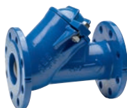
AVK serie 53/35 Balkeerklep met flensaansluiting Zinkende ge vulkaniseerde bal Nodulair gietijzer DN 50-600 Drukklass PN 10
