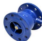
AVK Serie 876 Terugslagklep type "nozzle" RVS veer en ge vulkaniseerde gietijzeren klep Nodulair gietijzer DN 50-600 Drukklass PN 10/16
