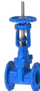
AVK serie 21/34 Flensafsluiter met stijgende RVS 316 spindel en handwiel Inbouwlengthe volgens EN 558-2 serie 3 Nodulair gietijzer DN 50-400 Drukklasse PN 10/16
