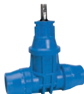
AVK serie 16/50 Dienstleidingafsluiter met trekvaste insteekverbinding voor PE buizen POM (Polyoxymethyleen) DN 25-50 Drukklasse PN 16
