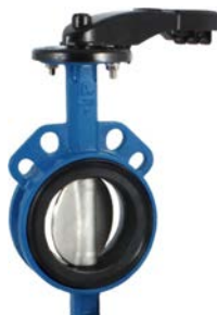
AVK serie 820/00 Centrische vlinderklep met losse voering Wafer type Inbouw lengte volgens DIN/EN558-1, serie 20 (K1) Nodulair gietijzer DN 25-1000 Drukklass PN 10/16
