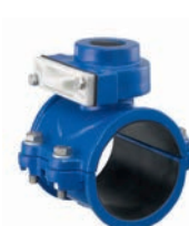
AVK serie 727/10 Aanboorzadel met shut-off blade Voor PE/PVC buizen DN 80-200 Drukklasse PN 16
