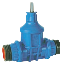
AVK serie 16/90 Dienstleidingafsluiter met PRK koppelingen voor PE buisen POM (Polyoxymethyleen) DN 25-50 Drukklasse PN 16
