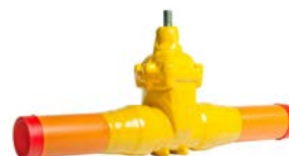
AVK serie 36/90 Afsluiter met PE100/ SDR11 uiteinden Vervangbare spindelafdichting Uitwendig voorzien van gele PUR coating Nodulair gietijzer DN 50-600 Drukklass PN 10
