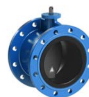
AVK serie 75/21 Centrische vlinderklep met ge vulkaniseerde voering Dubbel geflensd (lang), type EVFL Inbouwlengte DIN 3202-F4 Nodulair gietijzer DN 50-1000 Drukklass PN 10/16
