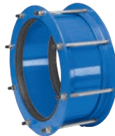
AVK serie 258 Op maat gemaakte rechte koppeling voor AC, stalen, grijs of nodulair gietijzeren leidingen Staal DN 350-2000 Drukklasse PN 8 t/m PN 25
