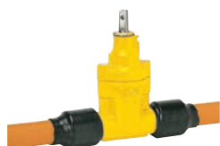
AVK serie 36/9X Dienstleidingafsluiter met PE uiteinden SDR11/PN10 of SDR17/PN4 Vervangbare spindelafdichting Nodulair gietijzer DN 25-50 Drukklass PN 10
