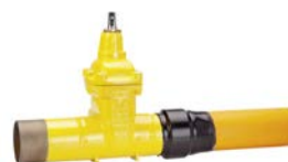
AVK serie 46/90 Schuifafsluiter met PE/Stalen spie-uiteinden Vervangbare spindelafdichting Uitwendig voorzien van gele PUR coating Gietstaal GP240GH DN 50-300 Drukklass PN 10
