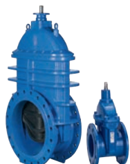
AVK serie 06/80 Flensafsluiter Korte inbouwlengthe, F4 RVS 304 spindel NBR schuif Nodulair gietijzer DN 40-1200 Drukklasse PN 10/16
