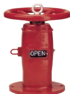
AVK serie 34/00 Post indicator, telescopisch Voor DN 50-600 post indicator afsluiters Gronddekking: 505-2210 mm Nodulair gietijzer UL/ULC listed FM approved
