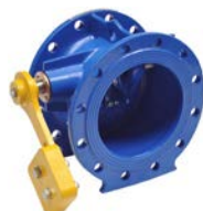
AVK serie 874 Terugslagklep type "Vlinder" met hefboom en gewicht Zacht dichtend Nodulair gietijzer DN 150-1600 Drukklass PN 10/16
