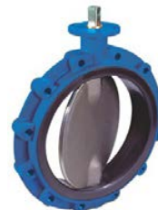
AVK serie 75/41 Centrische vlinderklep met ge vulkaniseerde voering Monoflens, type EVTLS Inbouw lengte DIN 3202-K1 Nodulair gietijzer DN 50-1000 Drukklass PN 10/16
