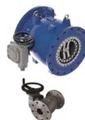
AVK serie 872 Naaldafsluiter met wormkast Nodulair gietijzer DN 80-1600 Drukklasse PN 10/16/25/40
