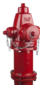
AVK serie 27/00 Bovengrondse brandkraan "Dry Barrel" Modern type 2 x 2" aansluiting + 1 x 4" motorspuitaansluiting Gronddekking: 305-2438 mm Nodulair gietijzer 250 PSI UL/ULC listed FM approved
