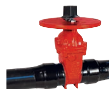
AVK serie 36/00 Afsluiter met PE100/SDR11 uiteinden Post indicator plaat Nodulair gietijzer DN 50-300 Drukklasse PN 16
