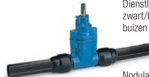
AVK serie 16/90 Dienstleidingafsluiter met PRK koppelingen voor PE buisen POM (Polyoxymethyleen) DN 25-50 Drukklasse PN 16
