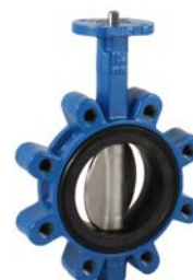
AVK serie 820/10 Centrische vlinderklep met losse voering Lug type Inbouw lengte volgens DIN/EN558-1, serie 20 (K1) Nodulair gietijzer DN 25-600 Drukklass PN 10/16
