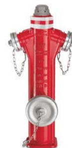
AVK serie 84/16 Bovengrondse brandkraan, type P7 met kogel, breekboutbeveiliging, 2x storzkoppeling en 1x motorspuitaansluiting Dubbele afdichting Nodulair gietijzer DN 100 1000-1500 mm Drukklass PN 16
