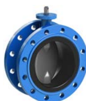
AVK serie 75/20 Centrische vlinderklep met ge vulkaniseerde voering Dubbel geflensd (kort), type EVFS Inbouwlengte DIN 3202-F16 Nodulair gietijzer DN 50-2000 Drukklass PN 10/16
