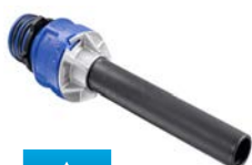
AVK serie 107/36 Supa Lock™ Fitting met PE uiteinde Ø 32-40 mm Nodulair gietijzer Drukklassse PN 16
