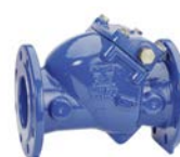
AVK Serie 41/61 Terugslagklep Zacht dichtend met gesloten asbussen RVS scharnier en ge vulkaniseerde stalen klep Nodulair gietijzer DN 50-300 Drukklass PN 16
