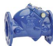
AVK serie 41/60 Terugslagklep Zachtdichtend met vrij aseinde RVS scharnier en ge vulkaniseerde gietijzeren klep Nodulair gietijzer DN 50-300 Drukklass PN 16
