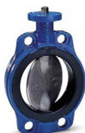
AVK serie 75/30 Centrische vlinderklep met ge vulkaniseerde voering Tussenbouw (Wafer semi-lugged), type EVBS Inbouwlengte DIN 3202-K1 Nodulair gietijzer DN 50-300 Drukklass PN 10/16
