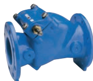
AVK serie 41/60 Terugslagklep Zachtdichtend met vrij aseinde RVS scharnier en ge vulkaniseerde gietijzeren klep Nodulair gietijzer DN 50-300 Drukklass PN 16
