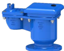
AVK serie 851/41 Ontlufter met dubbele opening ABS vlotter Nodulair gietijzer DN 50-200 Drukklasse PN 16
