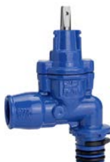
AVK Serie 103/31 Supa Lock™ Haakse dienstkraan voor zij-aanboring met spie- eind /push-in mofeind Nodulair gietijzer DN 32 Drukklassse PN 16
