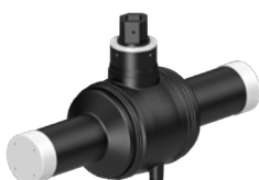
AVK serie 85/30 Kunststof kogelkraan met PE100/SDR11 lasuiteinden DN 50-150 Drukklasse PN 10
