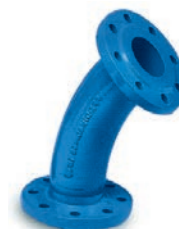
AVK serie 712 FFK 45° Flensbocht 45° Nodulair gietijzer Epoxy gecoat DN 50-1200 Drukklasse PN 16
