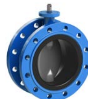
AVK serie 75/20 Centrische vlinderklep met ge vulkaniseerde voering Dubbel geflensd (kort), type EVFS Inbouw lengte DIN 3202-F16 Nodulair gietijzer DN 50-2000 Drukklass PN 10/16
