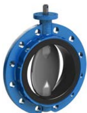
AVK serie 75/51 Centrische vlinderklep met ge vulkaniseerde voering Monoflens, type EVML Inbouw lengte DIN 3202-K3 Nodulair gietijzer DN 80-800 Drukklass PN 10/16
