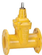
AVK serie 02/70 Flensaafsluiter Vervangbare spindelafdichting Lange inbouwlengthe, F5 Nodulair gietijzer DN 40-400 Drukklass PN 16
