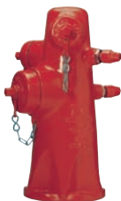
AVK serie 24/90 Bovengrondse brandkraan "Wet Barrel" 2 x 2½" aansluiting + 1 x 4" ¼" motorspuitaansluiting Nodulair gietijzer 200 PSI UL listed, FM approved
