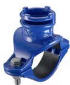
AVK Serie 100/14 Supa Lock™ Aanboorzadel voor gietijzeren / stalen buizen Ø 60-223 mm Nodulair gietijzer Drukklassse PN 16
