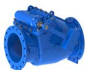
AVK serie 41/36 Terugslagklep Harddichtend met hefboom en gewicht Gesloten asbussen Nodulair gietijzer DN 350-600 Drukklass PN 16
