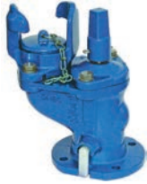
AVK serie 35/00 Ondergrondse brandkraan zonder insluibeveiliging Enkelvoudige afdichting Nodulair gietijzer DN 80 600 mm Drukklass PN 16
