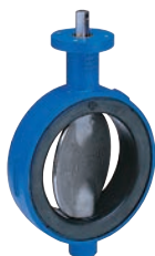
AVK serie 75/10 Centrische vlinderklep met ge vulkaniseerde voering Tussenbouw (Wafer), type EVS Inbouwlengte DIN 3202-K1 Nodulair gietijzer DN 40-1400 Drukklass PN 10/16
