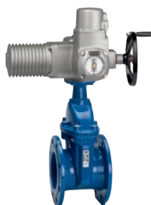
AVK serie 15/43 Flensafsluiter met ISO topflens voor elektrische aandrijving Korte inbouwlengthe, F4 RVS 316 spindel NBR schuif Nodulair gietijzer DN 40-400 Drukklasse PN 10/16
