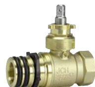
AVK serie 343/81 Supa Lock™ Kogelafsluiter met spie-eind/BSP draad 1"-1½" Messing DN 32 Drukklassse PN 16
