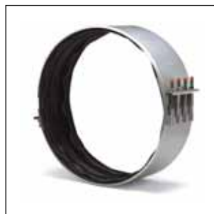
UK: uitwendige reparatieklem. Verkrijgbaar vanaf Ø 600 mm tot Ø 2000 mm.
